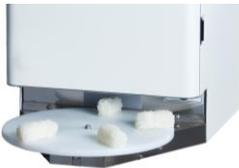
○連続して作る場合は、④の写真のように「しゃり投入口」のしゃりが常時投入口の上まで有る状態にしながら使用して下さい。投入口よりしゃり送りローラー(大)が半分以上見えてくると、寿司玉の形がくずれて出てきます。
